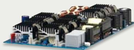
Modulo UPS da 1250.
